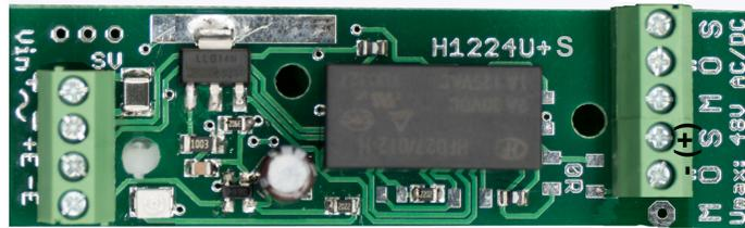
Diese Relaisplatine „H1224U+S“, die *ausschließlich* mit einer Gleichspannung versorgt werden kann, ist eine weitere Variante zur Baureihe „H1224U+...“.
