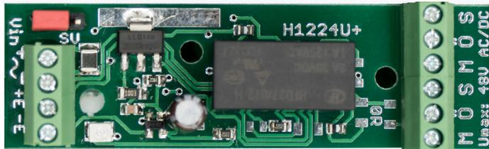
Diese Relaisplatine „H1224U+“ ergänzt die bisherige Miniatur – Relaisplatinen - Baureihe „2UM12..“ um zwei weitere Features: Zum einen ist sie neben einer Gleichspannung auch mit Wechselspannung zu betreiben, zum anderen erlaubt die Baugröße den Einbau in ein dafür vorgesehenes Hutschienengehäuse. Aufgrund dieser Universalität deckt sie ebenfalls den Bedarf vieler Anforderungen aus dem Bereich der Gefahrenmelde- und der Schwachstromtechnik ab.
