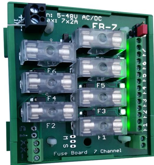
Foto: FB-7-C mit verdeckten Sicherungen im Hutschienengehäuse
